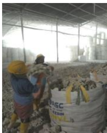
Gambar 7. Melakukan Memasukkan Batu Gamping kedalam bag (Sebelum perbaikan)
