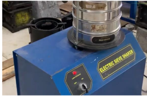
Gambar 1. Gambar Pengujian Analisa Saringan ( sieve shaker )
