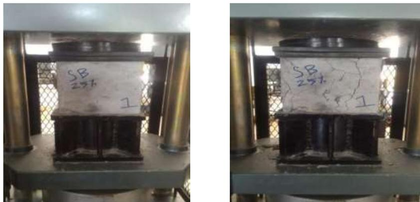
**Gambar 4.** Proses Uji Kuat Tekan pada Benda Uji
