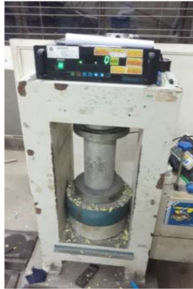
Gambar 3. Pengujian Kuat Tekan Beton.
