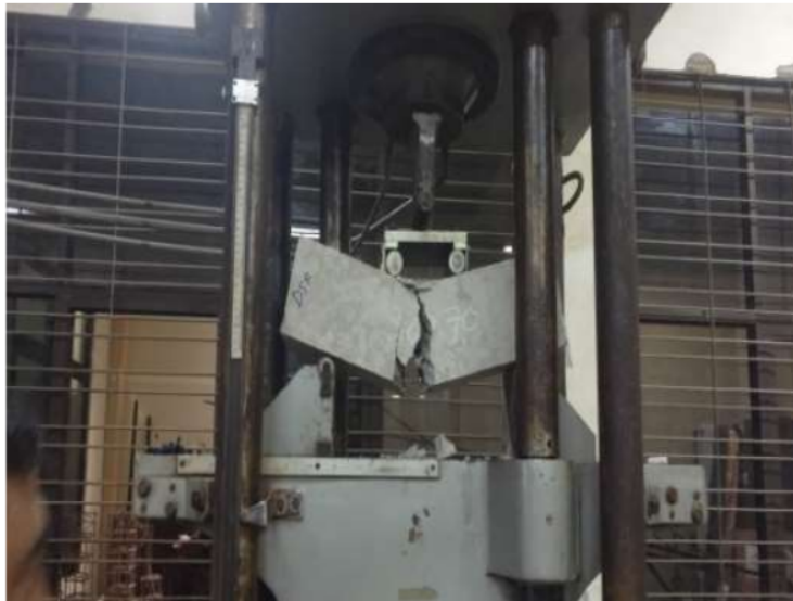
Gambar 5. Pengujian Kuat Lentur Beton
