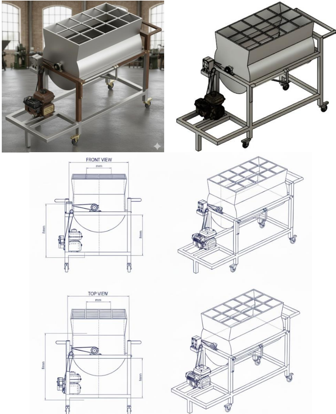
Gambar 1. Perspektif Desain 3D Mesin Pengaduk Media Jamur Sumber : Pengolahan Data, 2025
