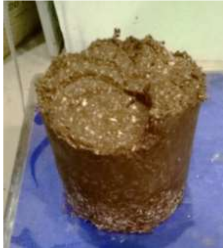
Gambar 8. Sampel Uji Pemadatan Tanah
